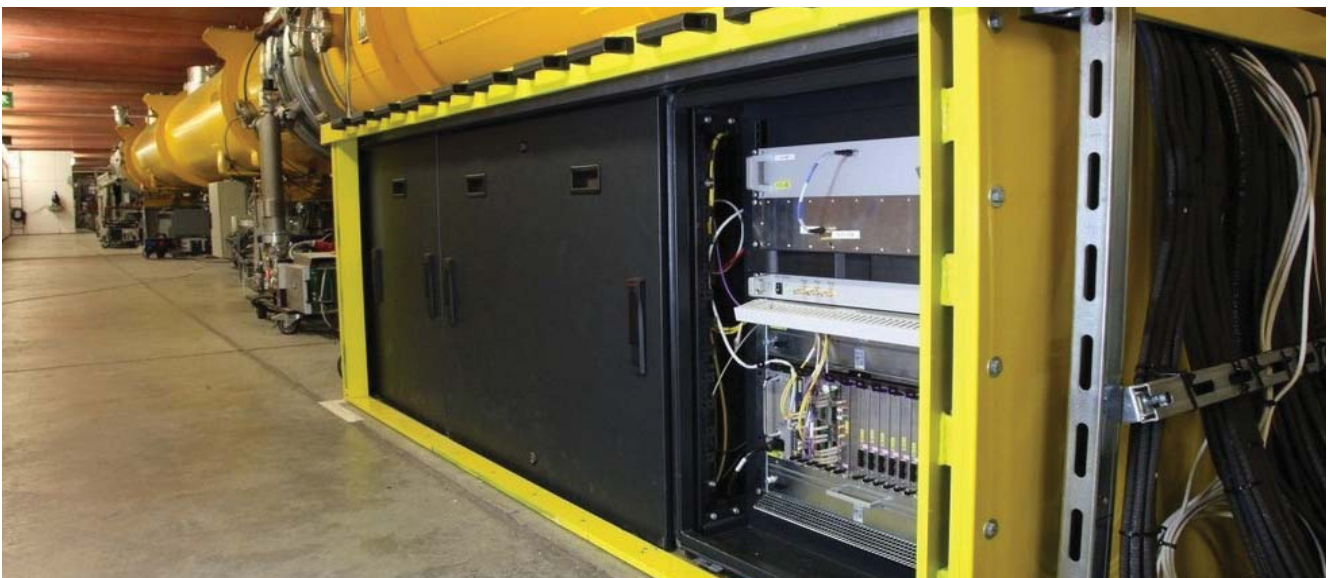
Abb.: Vollfunktionsfähiges Timing/LLRF Steuersystem auf Basis von MTCA.4 installiert in FLASH (Free electron Laser in Hamburg). Erzeugung von ultra-kurzen Laserblitzen (4,1 nm).
